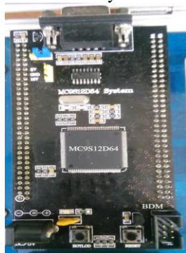
(b) Actual photo of minimum system
